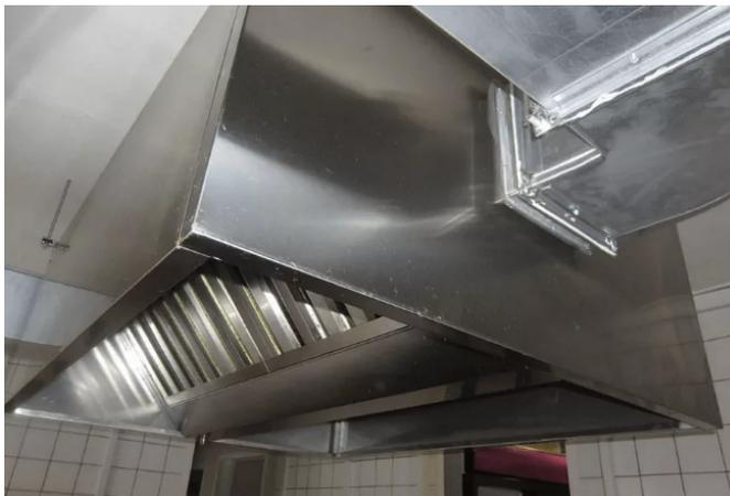
Все вытяжные зонты и комплектующие производства выполнены из высококачественной шлифованной нержавеющей стали и в рамках европейских стандартов производства и качества. Вытяжные зонты нашего производства имеют клапан слива жира на фасадной части, что является удобной и практичной функцией в случае частой жарки на открытых тепловых поверхностях.
